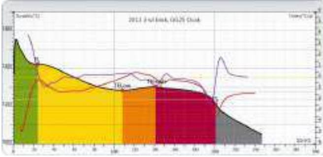
Şekil 7. 2 numaralı GG25 denemesi termal analiz sonuçları.
