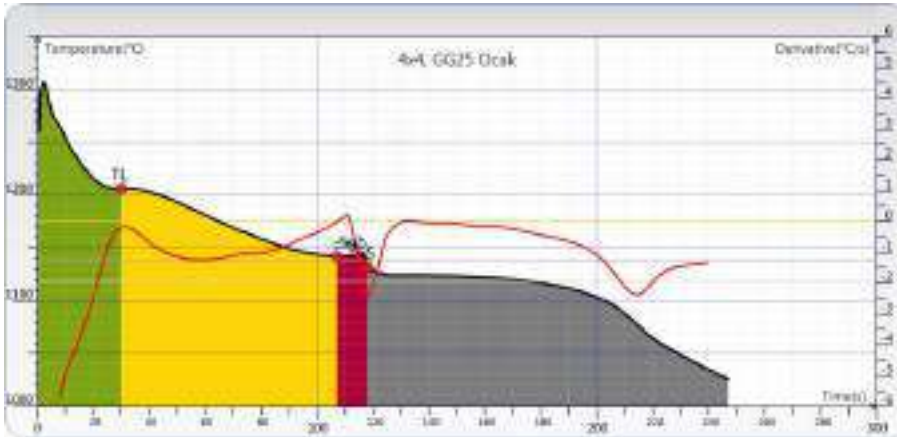
Şekil 5. Dökümü yapılan alaşımın soğuma eğrisi
